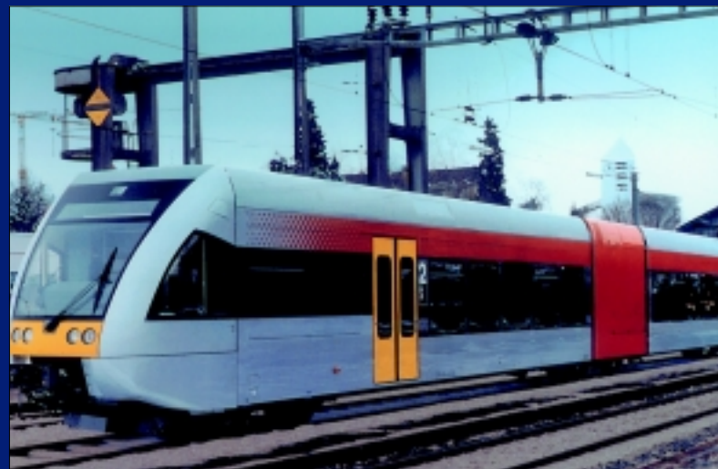
Niederflur-Gelenktriebwagen GTW 2/6 der Hessischen Landesbahn: Geräuscharm dank des Einsatzes von DIAB-Komposit-Sandwichmaterialien
