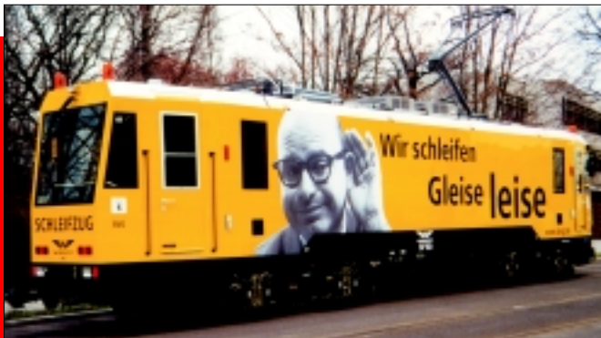
Windhoff-Fahrzeug der BVG, 400 kW-Antrieb, 13 Meter Länge und 32,5 t Betriebsgewicht.
